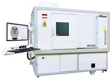
Nikonの計測用CT装置、MCT225を使用しています。光学式測定機と異なり、金属部品の表面反射による影響がないため、表面被覆などの前処理が不要です。さらにX線の特性から、非破壊で内部構造の形状数値データを取得できるため、内歯車の測定に使用されています。
