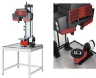
gom社の光学非接触3次元測定機を導入して10年近くたちます。当時、光学式の測定機の中で最も解像度が高い撮影ができるとして、発売後まもなく購入したのですが、すでに光学式測定機の限界に到達する解像度であったため、現在でも光学式非接触3次元測定機の中では、微小なものを最も高い解像度で測定できるタイプの測定機です。
