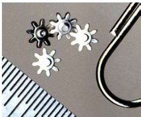
ピニオンギヤ:直径 2.95mm
