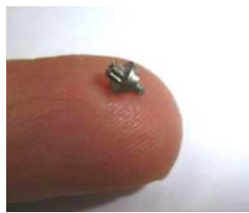
指とギヤ部品:直径 0.60mm
